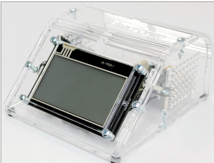
Die aufgebaute Tischwetterstation mit transparentem Gehäuse – startklar zum Programmieren (Bild 1)
